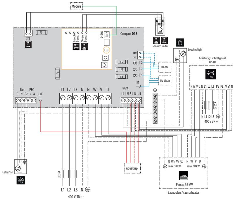
Das Beispiel zeigt den Anschluss mit diversen optionalen Zusatzgeräten / Modulen, sowie mit einem optionalen Leistungsschaltgerät PEB (Schaltlastenerweiterung).
