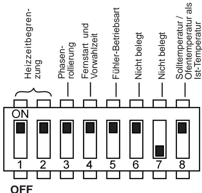
**Abb.5 Funktionswahlschalter - Standardeinstellung**
