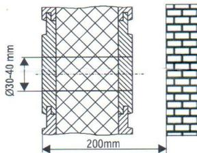
**2. Schritt:** Anschlußleitung (4m lang, 5-adrig) vom Steuergerät kommend und von der Kabinenaußenseite durch das  $\varnothing$ 30-40 mm Loch durchstecken. Mit Sensor Klemmen verbinden und sichern.
