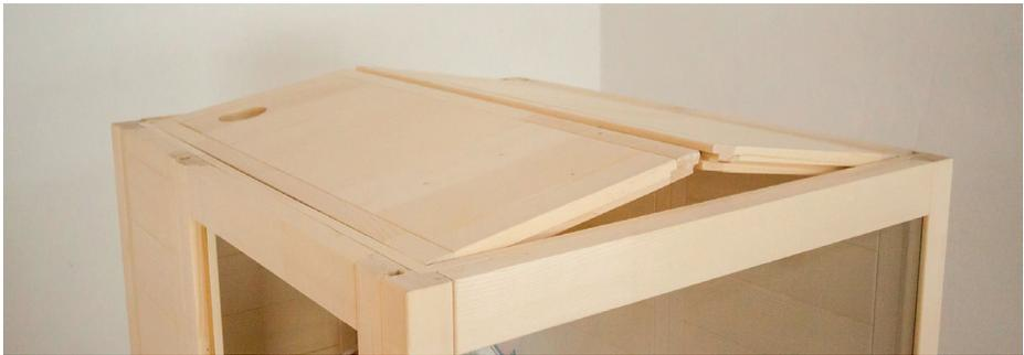
**Abb. 15: Befestigen der Dachelemente**
