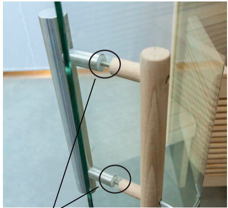
Kunststoff-Beilagscheiben bei Niro-Griff beilegen
